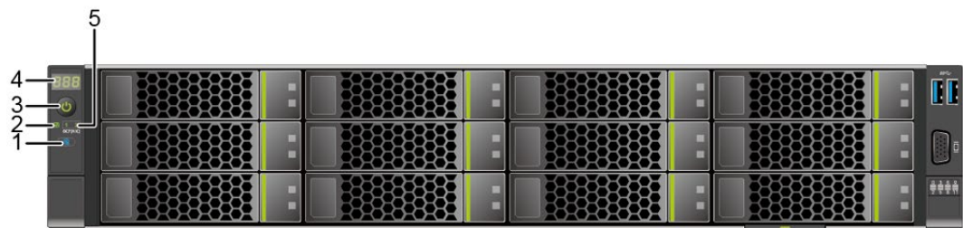
图3-7 前面板指示灯和按钮（以 12x3.5 英寸硬盘配置为例）
