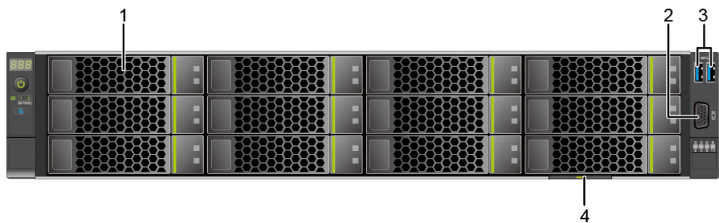
图3-1 12x3.5 英寸硬盘配置前面板组件
